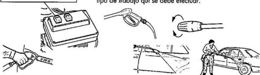
Al terminar el trabajo pulsar sobre el interruptor correspondiente para apagar el grupo bomba/motor, cerrar el grifo de agua y accionar el gatillo de la pistola para vaciar la presión que queda en la bomba.
